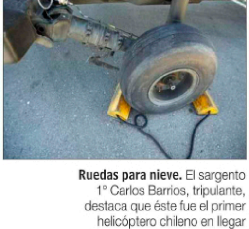
Ruedas para nieve. El sargento 1° Carlos Barrios, tripulante, destaca que éste fue el primer helicóptero chileno en llegar desde el continente americano hasta la Antártica. Posee en sus ruedas un mecanismo que permite adherirle esquíes para la nieve.
