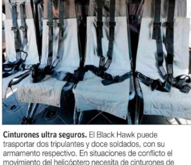
Cinturones ultra seguros. El Black Hawk puede transportar dos tripulantes y doce soldados, con su armamento respectivo. En situaciones de conflicto el movimiento del helicóptero necesita de cinturones de seguridad especiales de cuatro puntos de agarre. Los cinturones poseen un sistema de seguridad de cuatro correas cruzadas al pecho del soldado, con un disco central que se gira y permite soltarse rápidamente al momento de entrar en acción.
