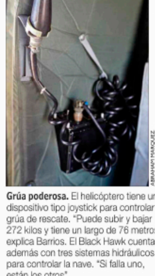
Grúa poderosa. El helicóptero tiene un dispositivo tipo joystick para controlar la grúa de rescate. "Puede subir y bajar 272 kilos y tiene un largo de 76 metros", explica Barrios. El Black Hawk cuenta además con tres sistemas hidráulicos para controlar la nave. "Si falla uno, están los otros".
