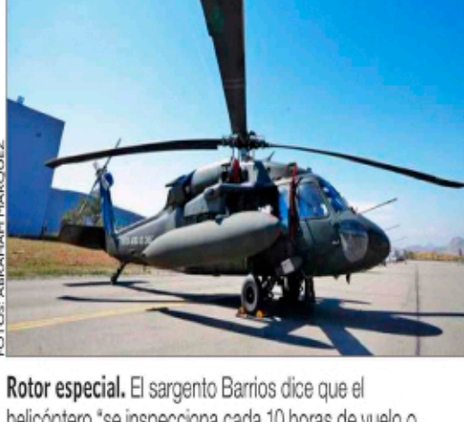
Rotor especial. El sargento Barrios dice que el helicóptero "se inspecciona cada 10 horas de vuelo o cada 14 días". El rotor se mueve entero y para todos lados, a diferencia de otros helicópteros: "Posee adelanto y retardo, filapeo y cambio de paso. Y es de fácil mantenimiento porque sus rodamientos son de caucho con placas de acero, no necesitan engrase".
