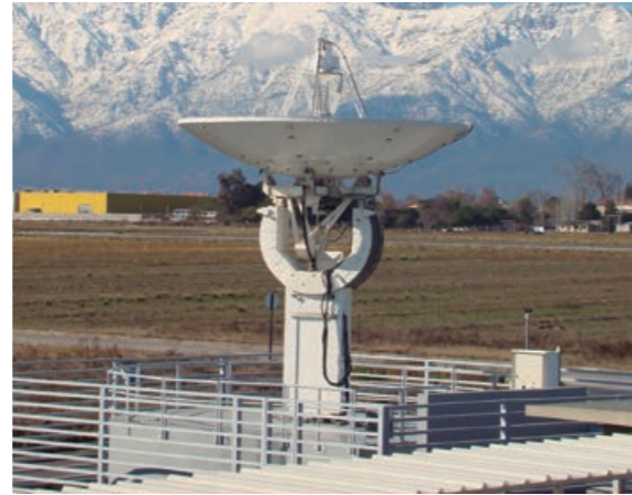
La antena satelital recibe los datos del satélite FASat Charlie.
