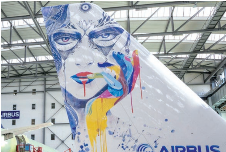
Las imágenes se imprimen directamente en la superficie del avión.
