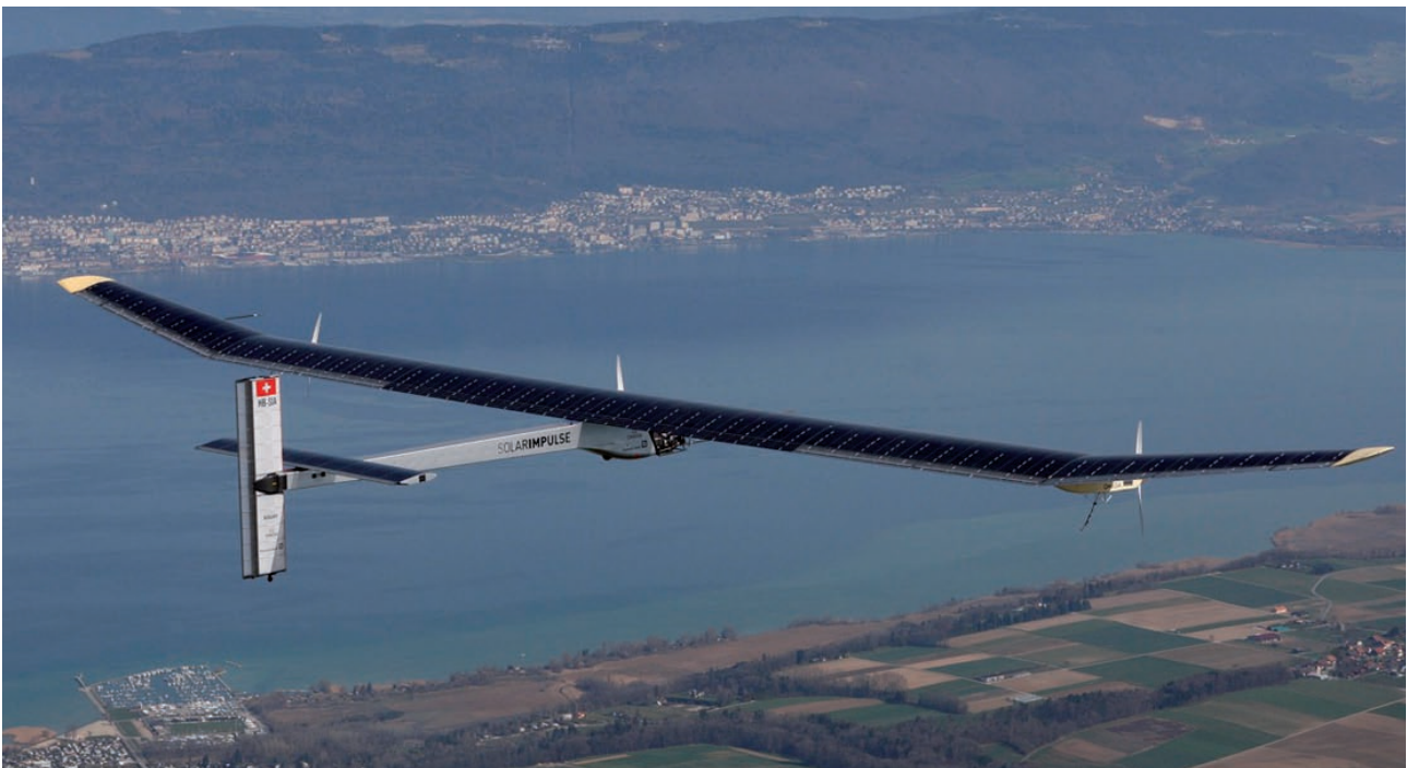
La aeronave está diseñada para volar a una altitud de crucero de ocho mil metros y así cargar sus baterías.
