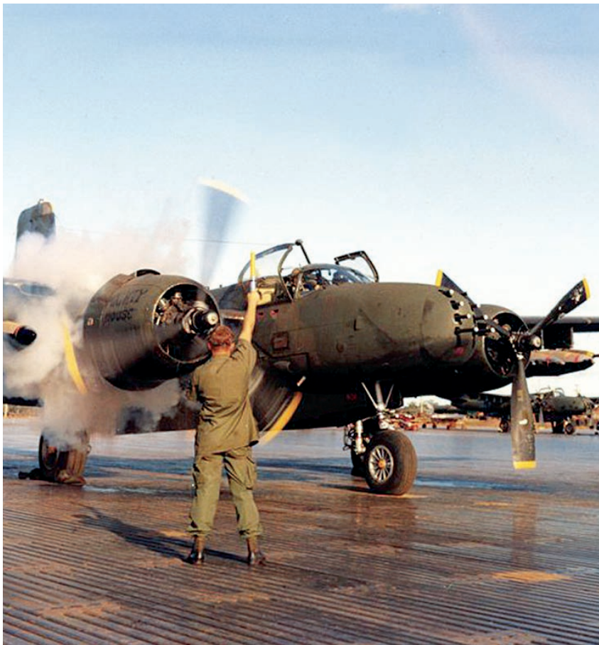
El B-26 K estaba dotado de ocho ametralladoras.50 en la nariz y ocho puntos duros bajo sus alas para llevar 3.600 kilos de armamento, más 1800 kilos de bombas en su interior.
