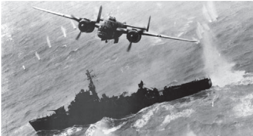
Bombardeo mediano North American B-25 "Mitchell". El modelo B-25J, podía llevar 13 ametralladoras .50 más 1.400 Kg. en bombas.
