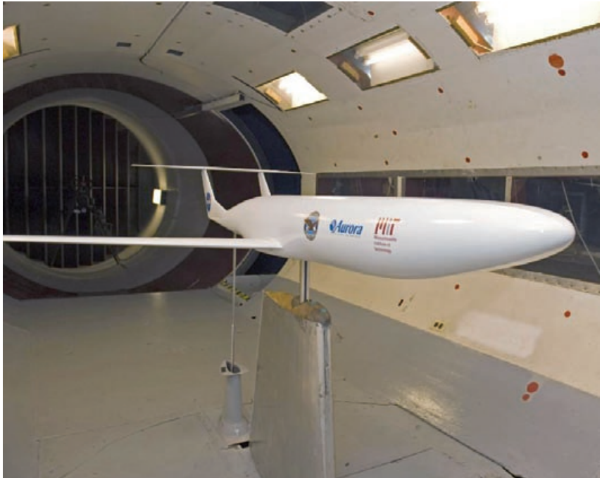
El modelo del futuro avión comercial D8, es probado en el túnel de viento de la NASA.
