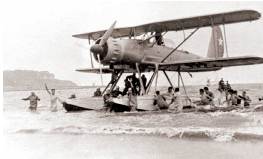
Hidroavión alemán Arado Ar 95 de dotación de los Grupos de Aviación N° 2 y 6 los cuales también podían ser operados con tren de aterrizaje fijo.
