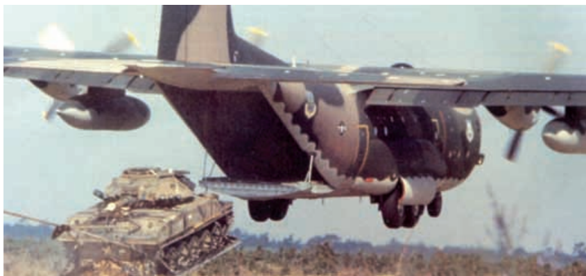
Mediante el sistema de descarga en vuelo rasante, se pueden lanzar desde la rampa, cargas pesadas como lo muestra esta imagen de un C-130 estadounidense lanzando un tanque.
