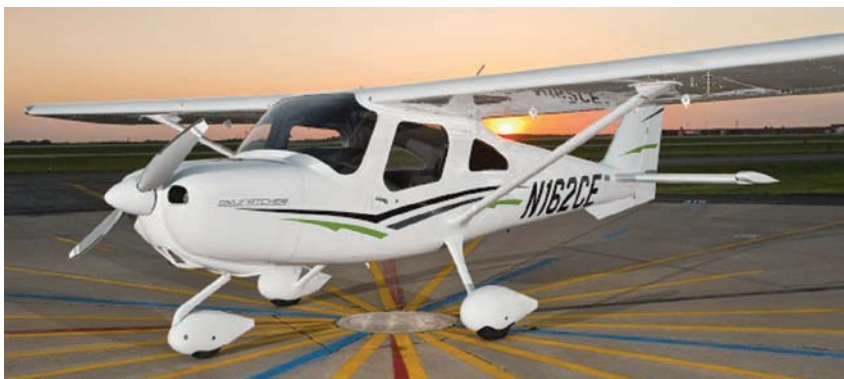
El Skycatcher pesa apenas 376 kilos y con su combustible puede volar a distancias de hasta 870 Kmts.
