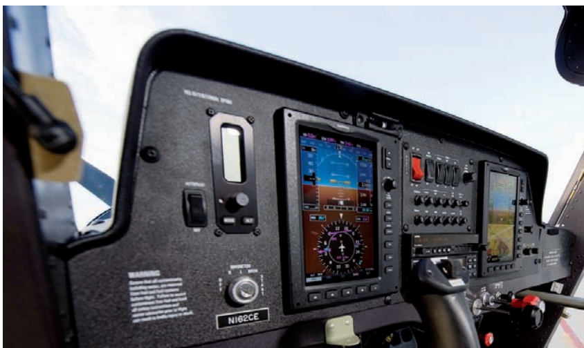
Su moderno panel de instrumentos de vuelo facilita el trabajo del piloto en la cabina.
