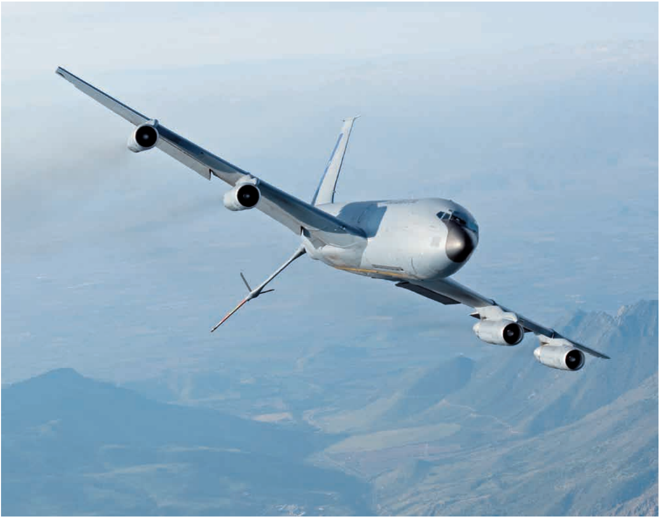
Avión tanquero KC-135, para reabastecimiento en vuelo de las aeronaves de combate.
