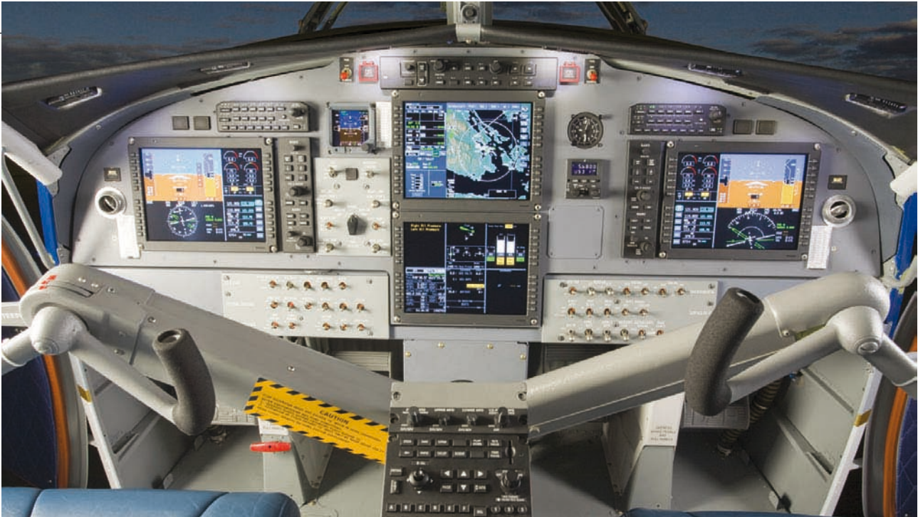
El nuevo panel de instrumentos donde se observan sus pantallas digitales de multifunción.
