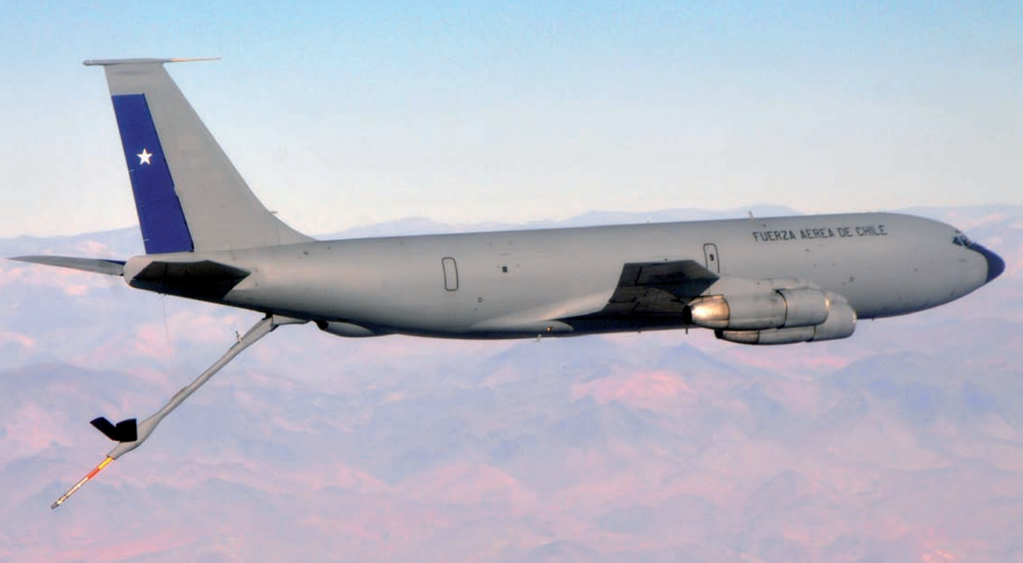
Boeing KC-135E “Stratotanker” de la Fuerza Aérea de Chile con su lanza telescópica extendida, por intermedio de la cual es capaz de suministrar más de dos mil litros de combustible por minuto.
