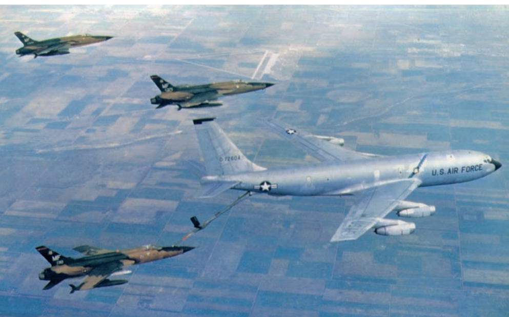
Boeing KC-135 abasteciendo de combustible en vuelo a aviones Republic F-105 "Thunderchief".
