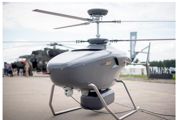
Dron VR-Technologies VRT-300, diseñado como UAV de doble rotor principal, destinado para ser ofrecido en mercados civiles y militares, uno de los desarrollos rusos en materia de helicópteros UAV
