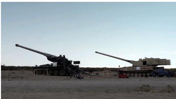
Como parte de la prueba del ABMS de la USAF, el reciente ensayo se llevó a cabo entre el 31 de agosto y el 4 de septiembre pasados, y en el cual un SISTEMA AVANZADO DE ARMAS (AGS) montado en un obús autopropulsado M110 de 8 pulgadas (*en la imagen de arriba, a la izquierda*) disparó un proyectil de hiper velocidad (HVP) que derribó un blanco representado por un misil crucero sobre el Polígono de Misiles de White Sands.
