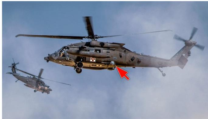
Esto proporcionaría un arco de cobertura a ambos lados, similar en general a cómo se instala el AN/AAQ-24(V)25 en los helicópteros navales CH-53E Super Stallion. Funciona exactamente de la misma manera, también, detectando los misiles de búsqueda de calor entrantes a través de los sensores de advertencia y luego indicando a los láseres que disparen a la cabeza del buscador de la amenaza, cegándola o confundiéndola y desviando el arma de su curso.
