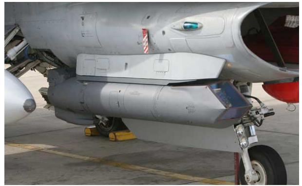
Sistema de puntería SNIPER en un caza F-16
