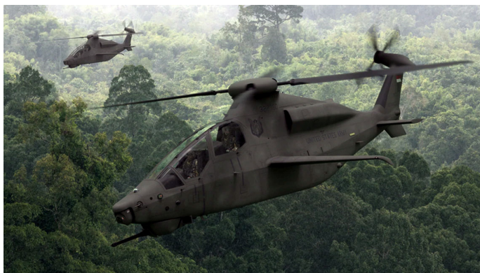
Nueva configuración de rotor de cola abierto, o tradicional, del Bell 360 Invictus
