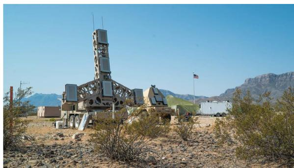
Un prototipo de radar de control de fuego utilizado para rastrear amenazas y pasar información a las armas diseñadas para derribar un objetivo se prueba durante el Sistema de Gestión de Batalla Avanzado Onramp 2 en White Sands Missile Range, Nuevo México, el 27 de agosto de 2020.
