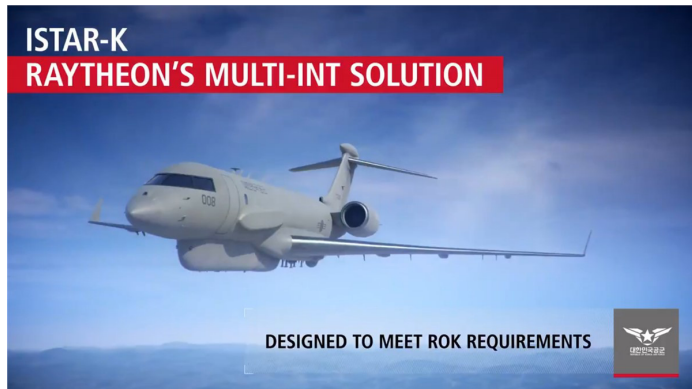
La solución ISTAR-K ofrecida a Corea en diciembre de 2020 se basa en un jet Bombardier Global 6500 de negocios, modificado
