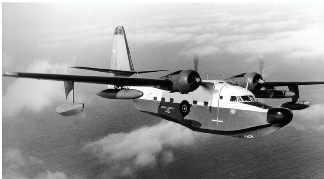
El Grumman HU-16B/ASW N° 568, durante una misión de patrullaje. Este anfíbio fue modificado junto a los N° 566 y 567 para realizar misiones guerra antisubmarina. (MNAE)
