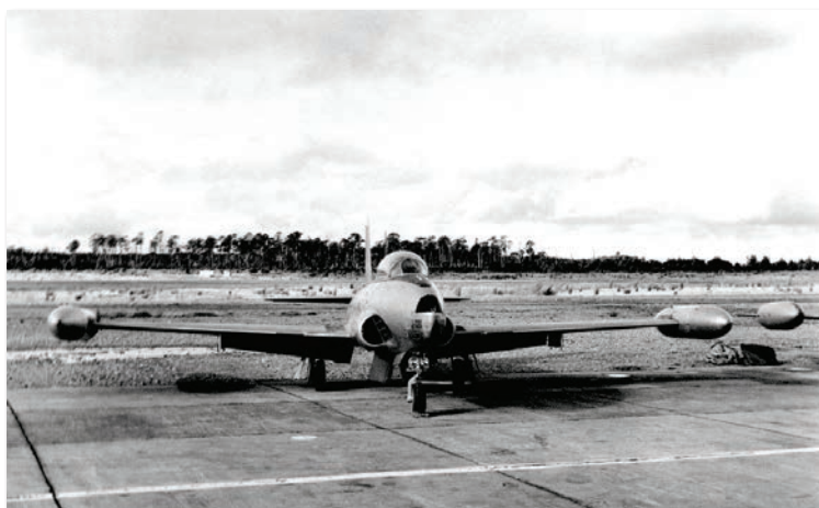
El Lockheed T-33A Shooting Star N° J-320 estacionado en la losa del Grupo de Aviación N° 9. Se observan los flaps y frenos de velocidad en posición abajo y el acabado metálico que mantuvieron estos aviones en esa unidad de combate. La mayor parte de la flota de Shooting Star estaba constituida por aviones de entrenamiento T-33A. En algunas publicaciones estos aviones son denominados “Silver Star”, lo cual es incorrecto. (MNAE)
