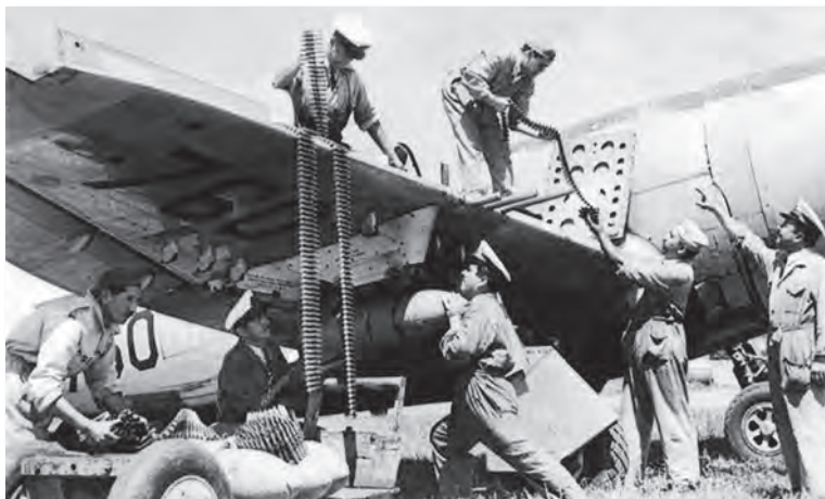
Armeros del Grupo de Aviación N° 11 realizan un carguío táctico al P-47D Thunderbolt N° 760. Se observa el carguío de las ocho ametralladoras calibre .50” y de bombas de 250 lb. (MNAE)
